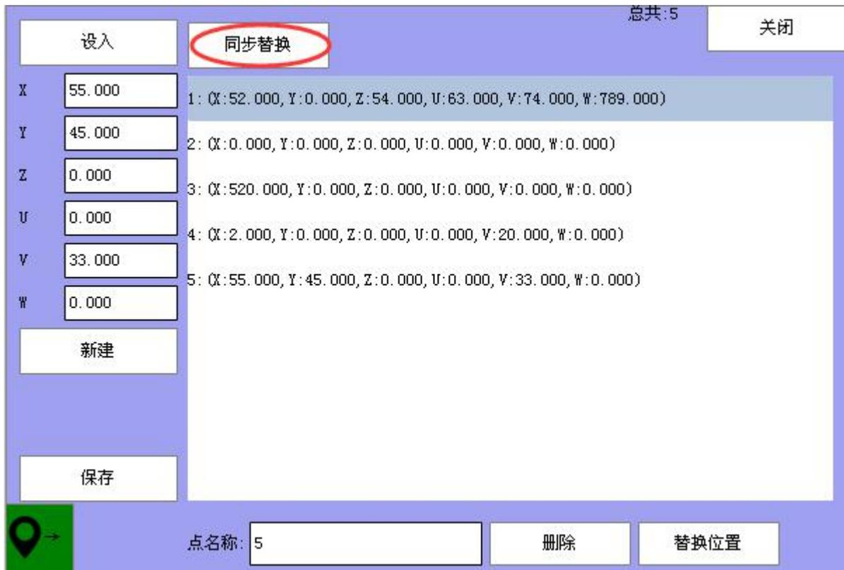
2、点击第一个点把当前点的坐标值修改成图纸原点（第一个点）的坐标值，最后点击【保存】按钮即可，如下图所示：
