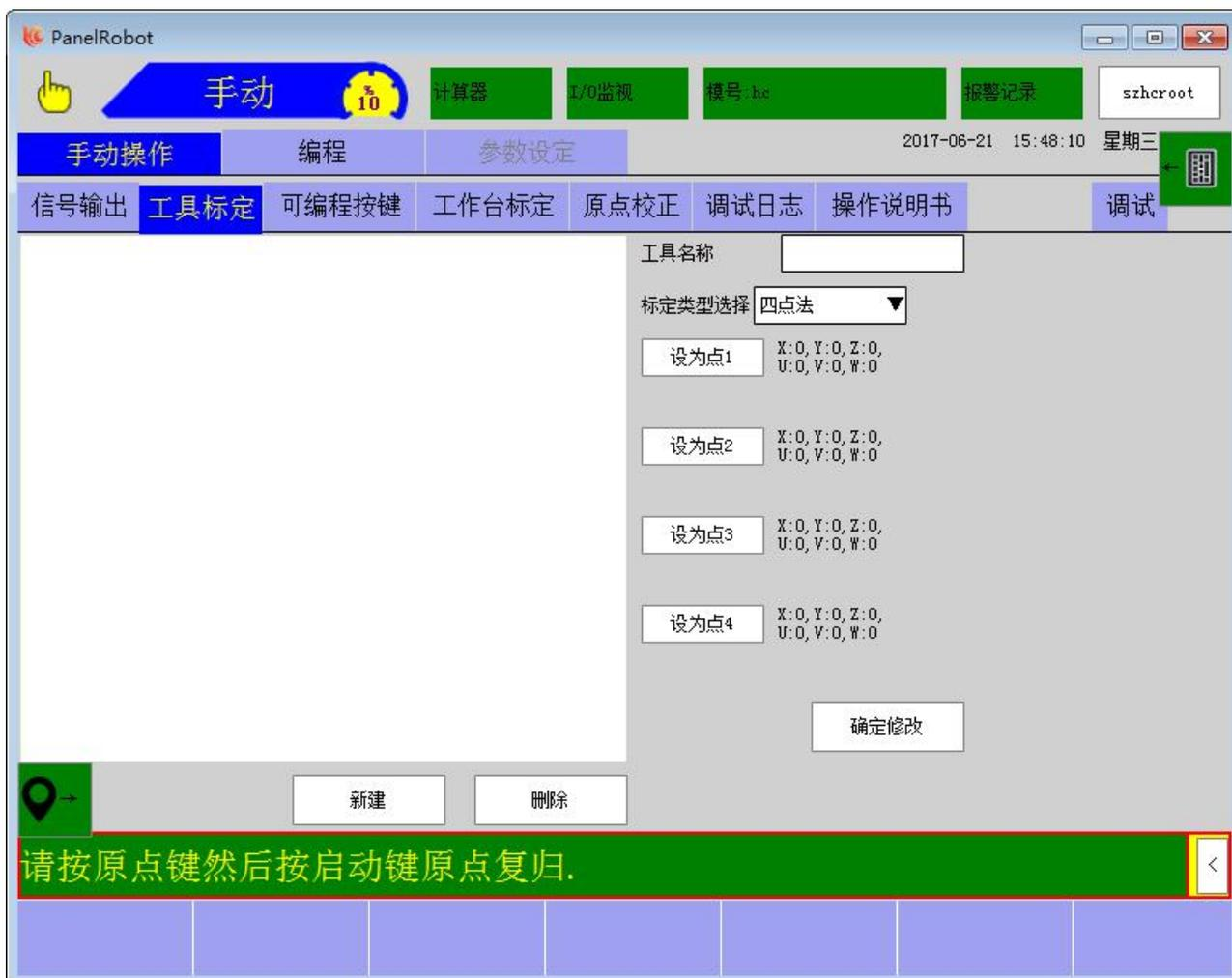
建立了工具坐标系后，机器人的控制点也转移到了工具的尖端点上，这样示教时可以利用控制点不变的操作方便地调整工具姿态，并可使插补运算时轨迹更为精确。
