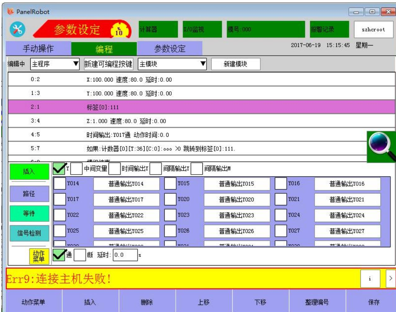
输出信号插入方法：选择输出点类型（Y/中间变量/时间输出 Y）→选择输出点的通断（通/断）状态→设置延时时间→点击【保存】按钮→在教导页面选择需要插入的位置的下一步单击【插入】即可。
