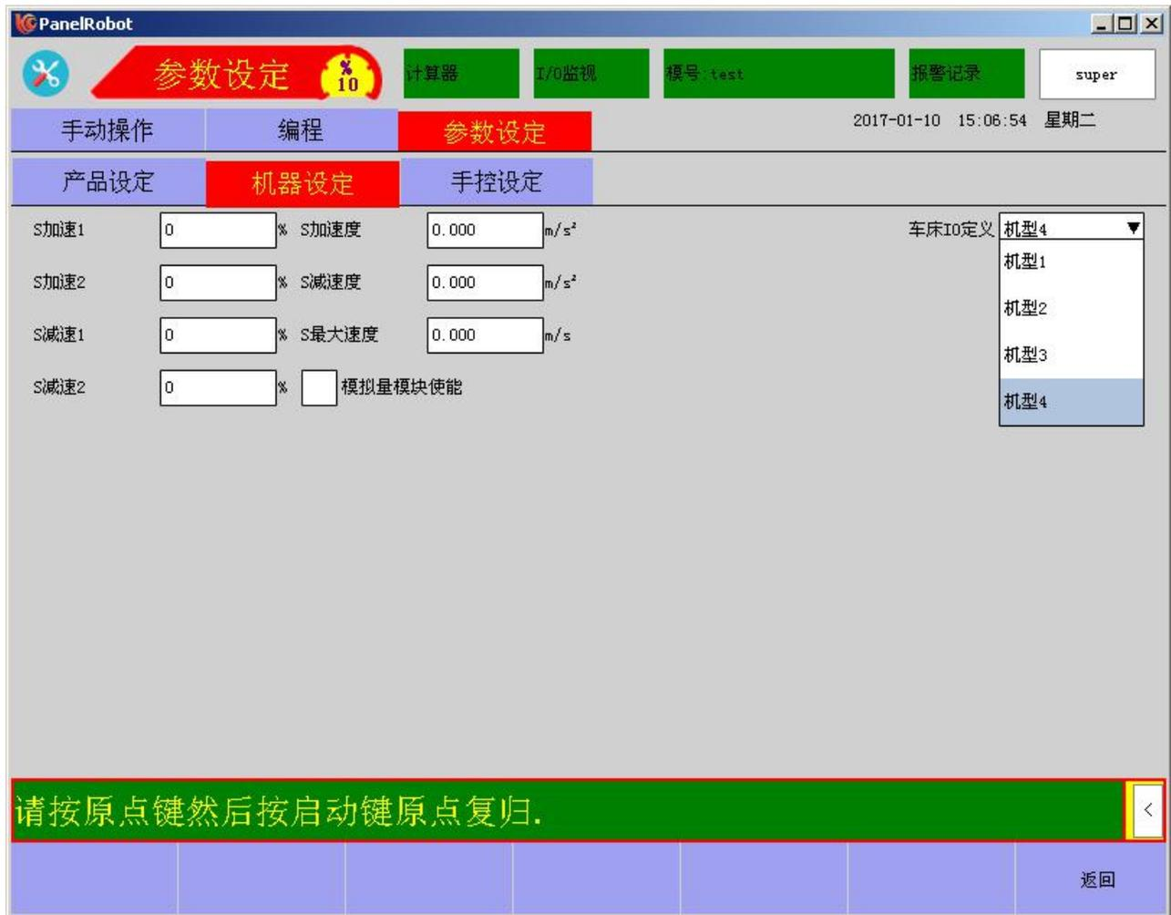
1、车床 IO 定义：下拉三角箭头会有两个选项，选择机型 1 表示一个机械手控制两台车床，选择机型 2 表示一个机械手控制一台车床，进行机型切换时相应的 IO 定义会改变。
