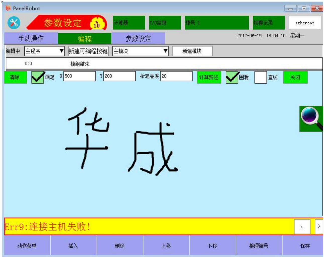
点击画板，勾选画笔，用工作台标定平面，再确定 X 轴和 Y 轴的长度及抬笔高度，然后在画板上写字如上图“化成”写完之后点击计算路径。关闭画板，点击编辑点位会自动生成下图点位。
