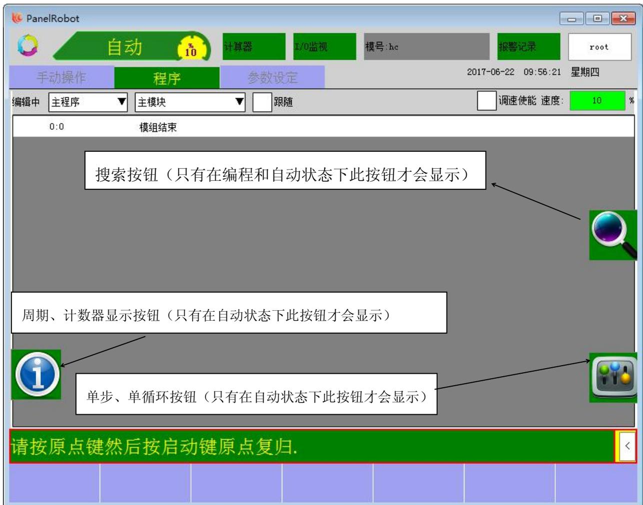
调速使能：勾选后按手控器上的键速减速键可对全局进行调速。
