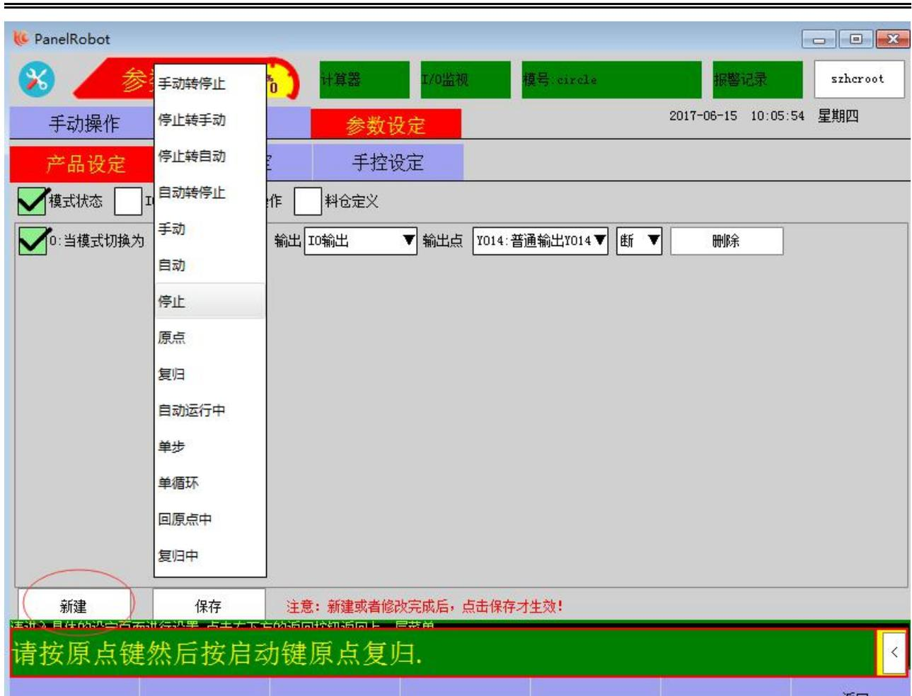
首先点击新建将其勾选，然后在“当模式切换为”选择相应的状态，如：手动，自动，自动转停止等等。再在“输出”里选择 IO 输出或者 M 值输出，然后在“输出点”里选择相应的点。如前面选择“输出”，这里则选择输出点“普通输出 YXX”。如果是选择的“M 值输出”这里则选择输出点“MXX”。
