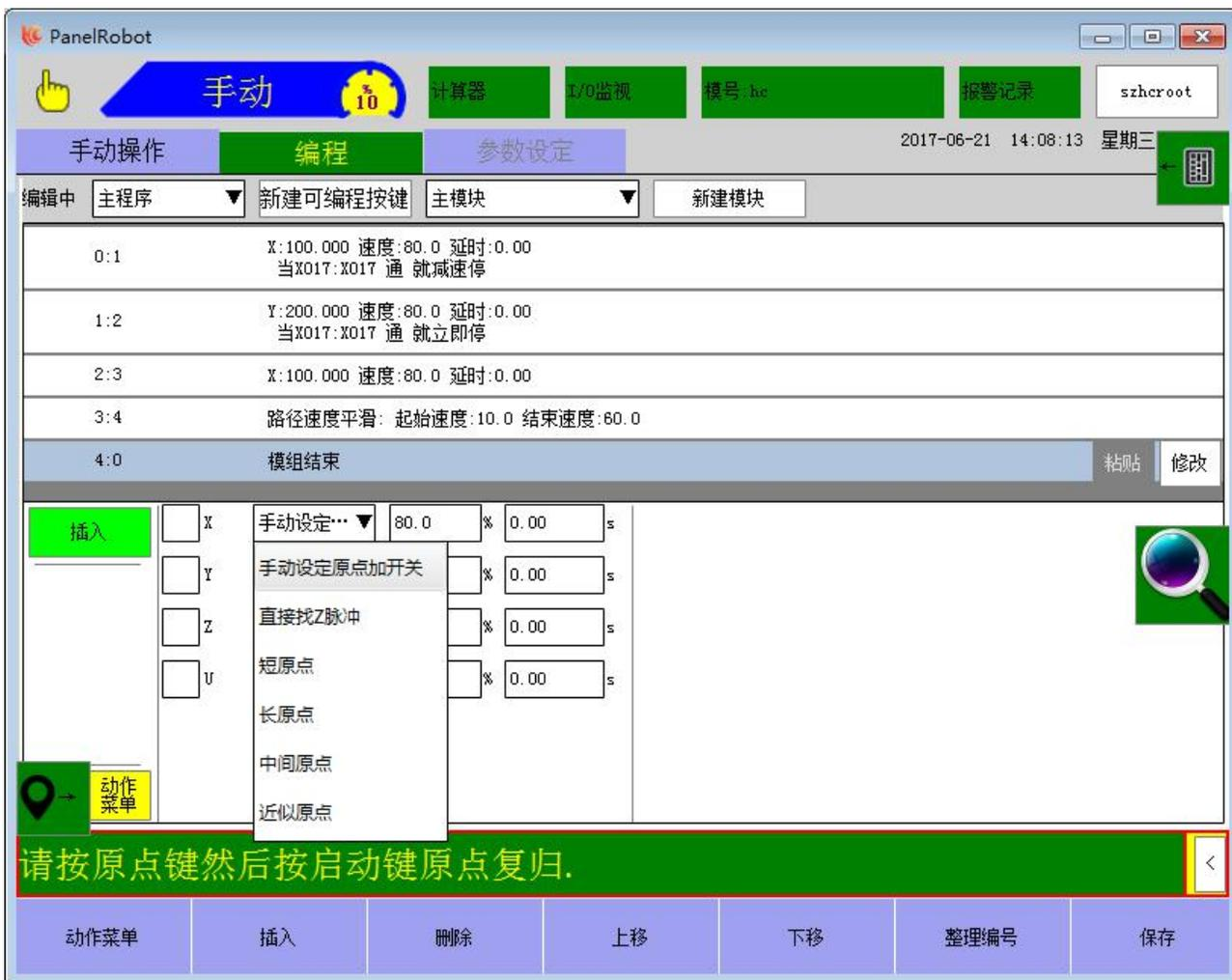
原点指令作用：此界面下可设置轴回原点的顺序及速度。
