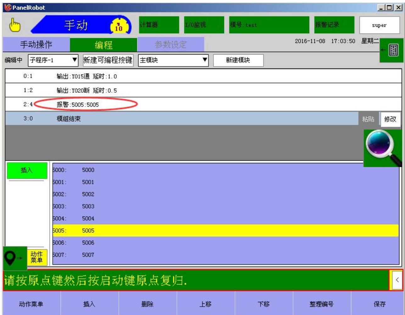
选择报警编号再点击【插入】按钮即可把报警插入程序中，当程序运行到“报警程序”时机械手停止运行并弹出报警内容。
