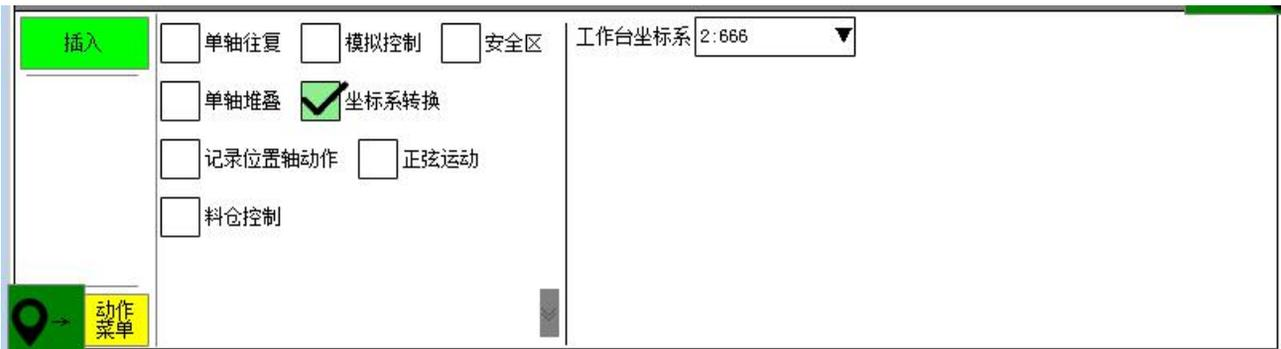
坐标系 ID: 输入的 ID 号跟工作台标定里新建的坐标系的 ID 号有关, 如果使用新的坐标系则一定要在编程的最前面插入坐标系 ID 号。
