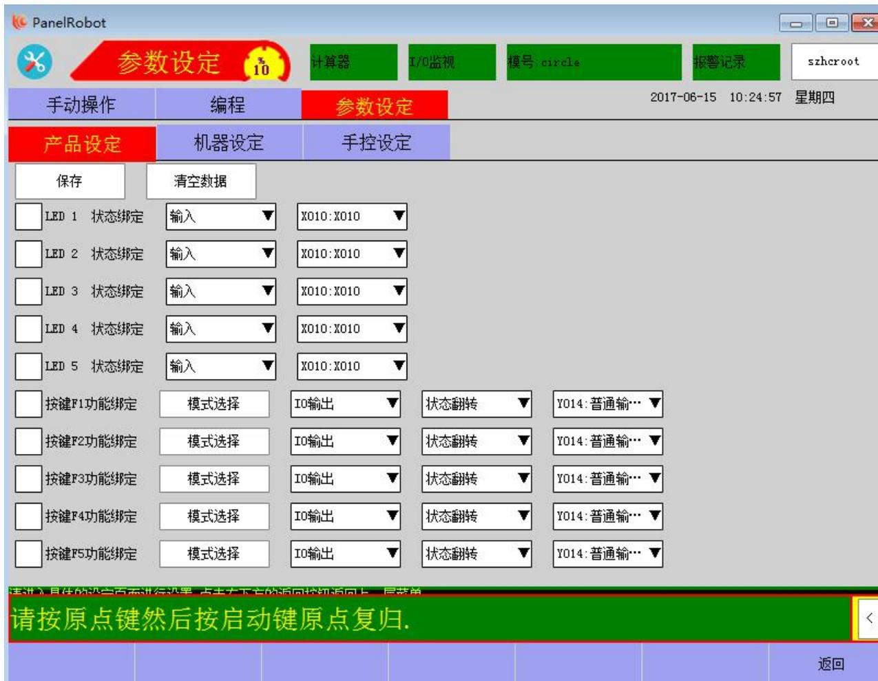
LED1--5 状态的功能和 IO 设定一样。选择相应的输入、输出和 M 值来决定手控器上的 LED 灯的亮暗。
